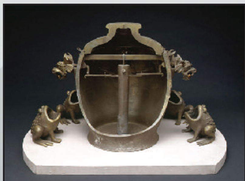
Reproduction du premier sismoscope inventé en 132 par le philosophe et mathématicien chinois Zhang Heng.
