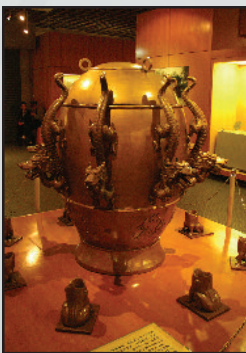
Reproduction du premier sismoscope inventé en 132 par le philosophe et mathématicien chinois Zhang Heng.
