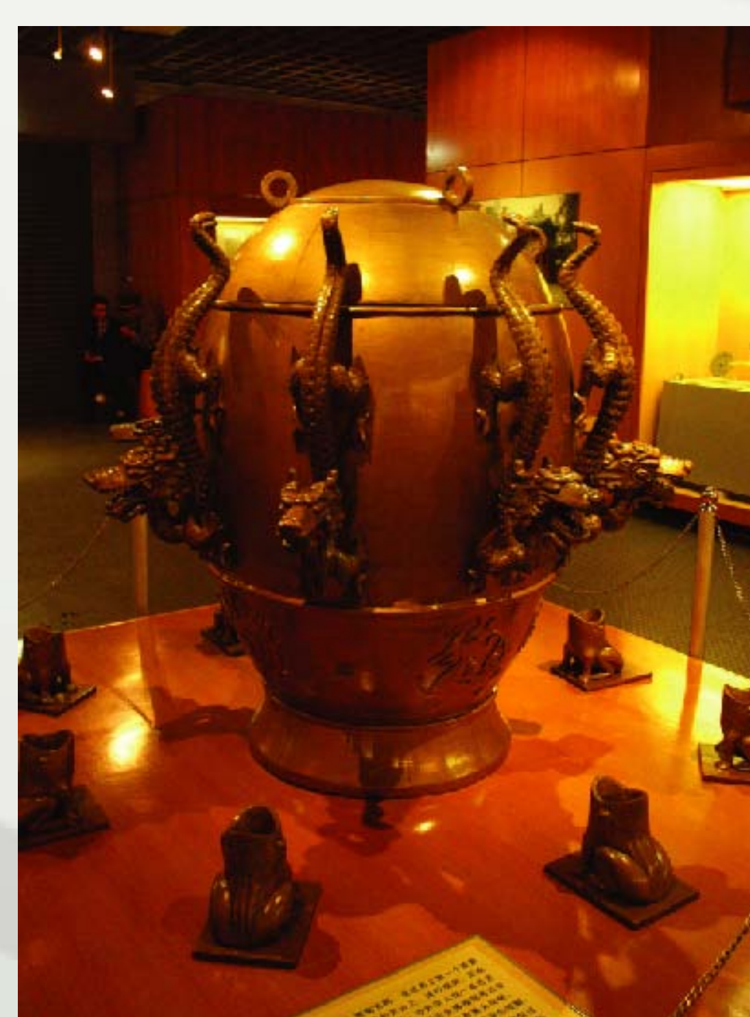
Το πρώτο σεισμοσκόπιο δημιουργήθηκε στην Κίνα το 132 μΧ από το φιλόσοφο Chang Heng
